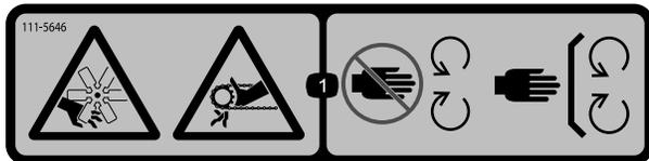
1. Risque de coupure/mutilation par le ventilateur et de coincement par la courroie – ne vous approchez pas des pièces mobiles et laissez toutes les protections en place.
