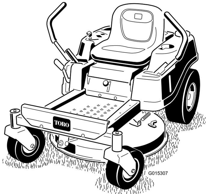
Esta máquina es un cortacésped con conductor de cuchillas rotativas, diseñada para ser usada por usuarios domésticos en aplicaciones residenciales. Está diseñado principalmente para segar césped bien mantenido. No está diseñado para cortar maleza, segar cunetas o medianas de carreteras o utilizarla en aplicaciones agrícolas.
