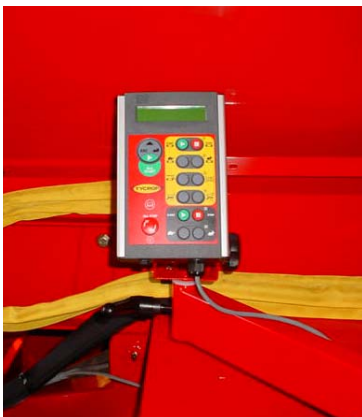
Figure 11 : Boîtier de commande sur bras pivotant
