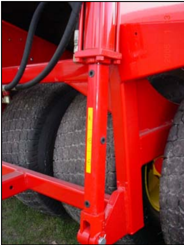
Figure 6 : Support de vérin hydraulique en place
