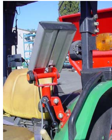
Figure 12 : Boîtier de commande sur support du tracteur
