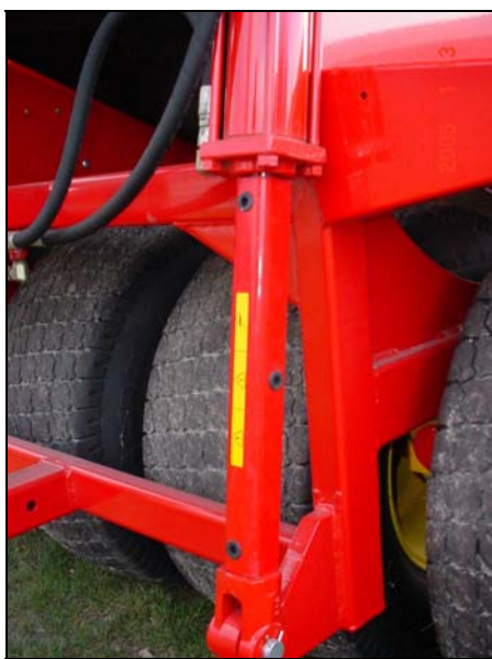
Figure 30 : Support de vérin hydraulique en place
