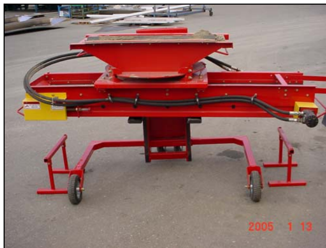
Figure 28 : Transporteur transversal sur le chariot pour accessoire
