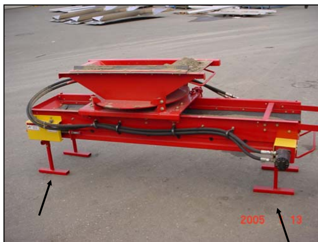
Figure 27 : Transporteur transversal sur les supports de rangement
