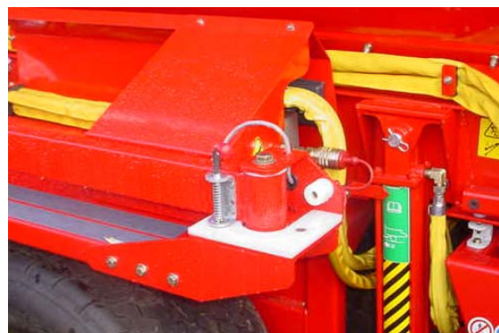
Figure 18 : Positionnement du bras pivotant de boîtier de commande
