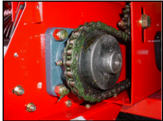
Figure 21 : Graisseur sur le modèle de base (un du côté arrière gauche et un du côté arrière droit)
