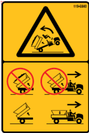
119-6840 : Risque de renversement Abaissez la benne avant de conduire la machine
