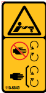
119-6843 : Risque de coincement N'utilisez pas la machine sans les protections
