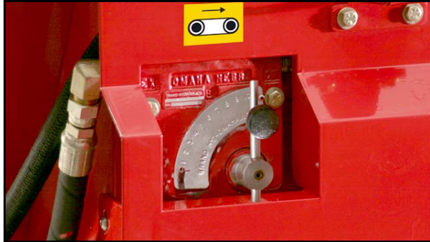
Figure 11 : Vanne de régulation de débit
