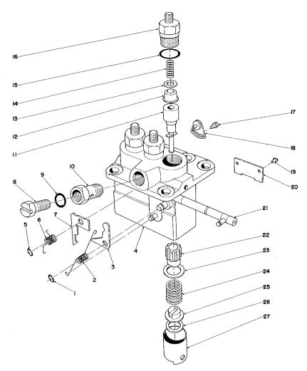
FUEL INJECTION PUMP ASSEMBLY NO. 42-8000 (Cont.)
