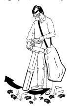
**IMPORTANTE**: No introduzca a la fuerza el tubo del aspirador en un montón de residuos, ni mantenga el tubo vertical mientras introduce residuos a la fuerza en el tubo. Ambas acciones pueden atascar y dañar el impulsor. Si el aspirador empieza a vibrar o hacer ruidos anormales, apáguelo, **desenchufe** el cable y compruebe la causa.
