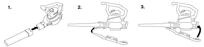
**IMPORTANTE**: Debe instalar el tubo del soplador antes de instalar la cubierta de entrada porque la cubierta de entrada se engancha en el tubo del soplador. El soplador no funcionará a menos que la tapa de la entrada inferior esté bloqueada en su lugar.
