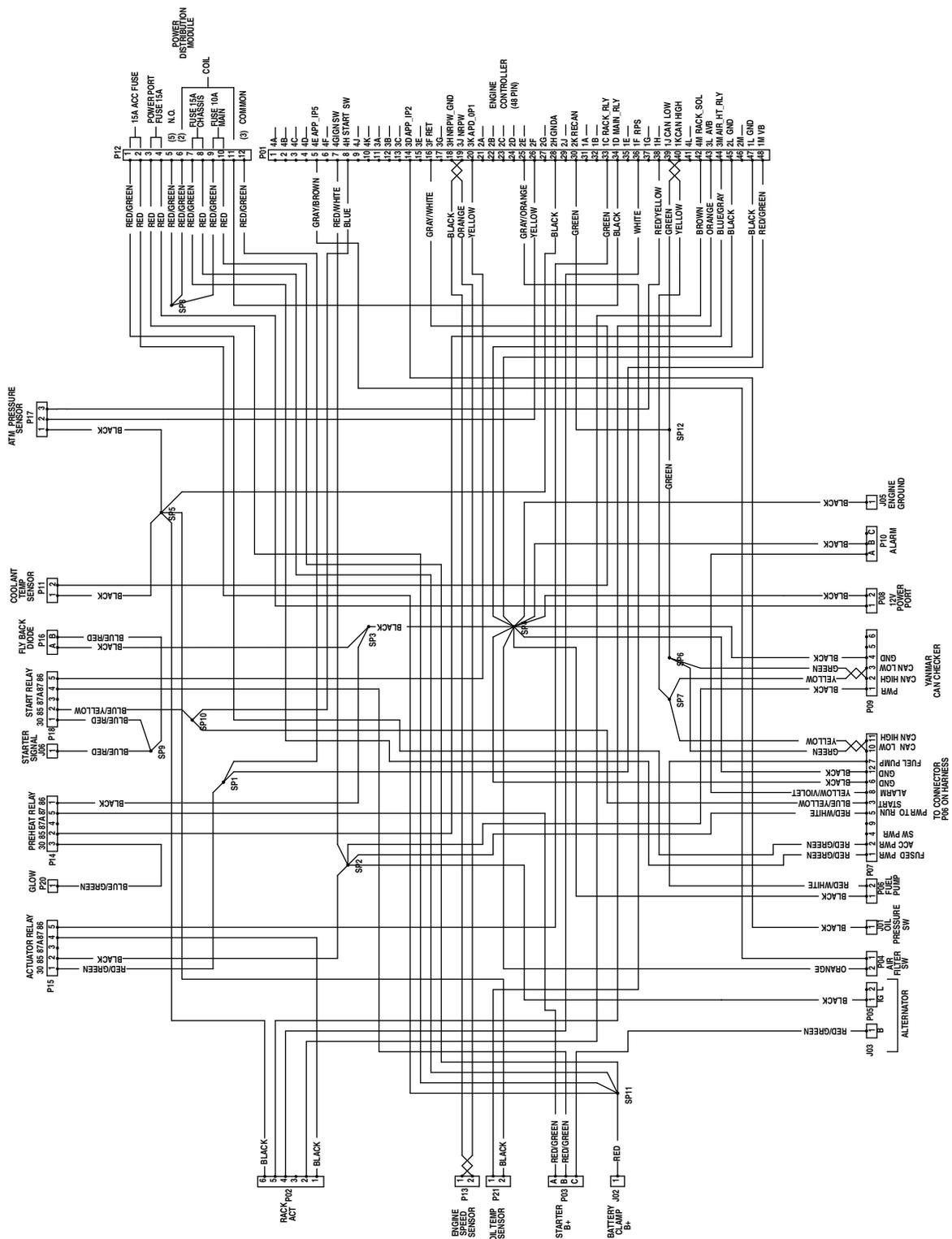
Schéma électrique – Moteur Yanmar 3TNV88C (Rev. A)
