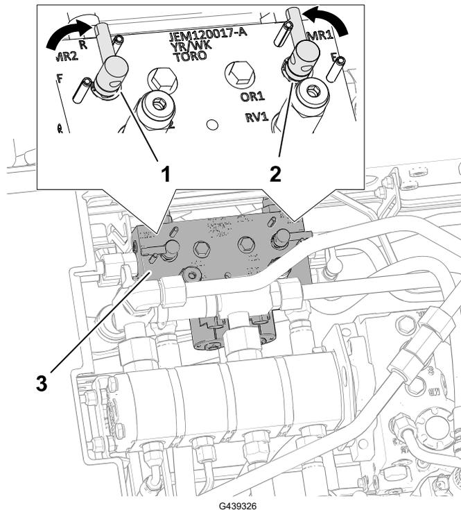
① Palanca de autoafilado (posición de autoafilado - unidades de corte delanteras)
