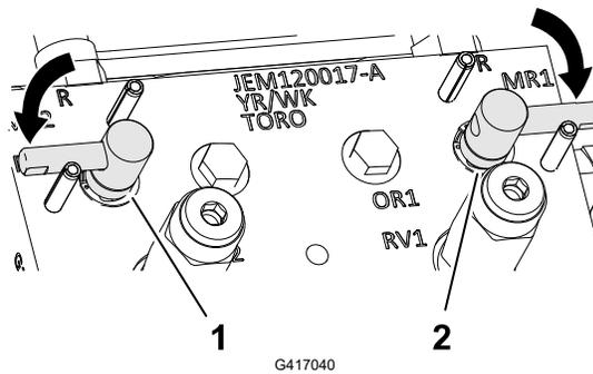
① Palanca de autoafilado (posición de siega - unidades de corte delanteras)
