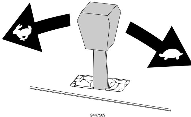
Mueva la palanca de control del acelerador hacia delante para aumentar la velocidad del motor y hacia atrás para reducir la velocidad.
