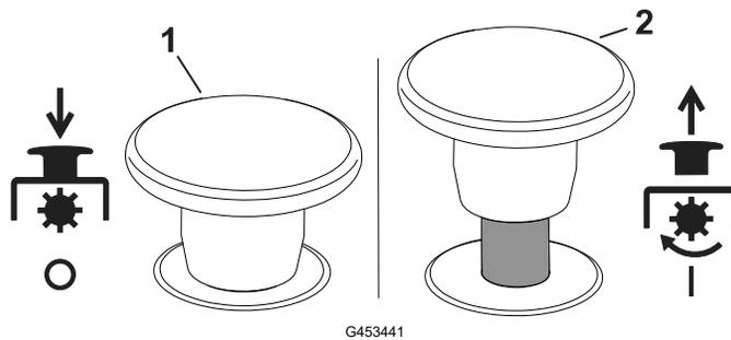
① Desengranar TDF - La máquina está en el modo de TRANSPORTE (permite conducir a una velocidad máxima de 16 km/h si la velocidad máxima no está limitada).
