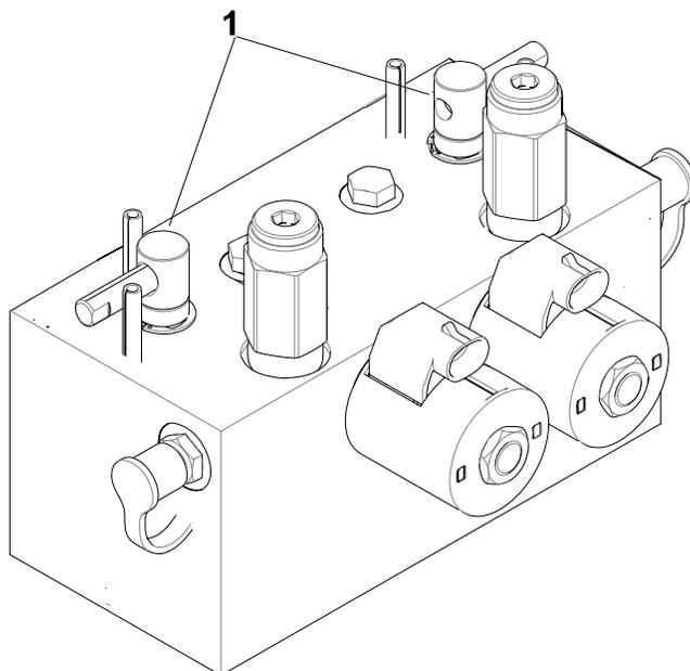
Las palancas de autoafilado ① se utilizan conjuntamente con la palanca Bajar/Segar/Elevar para autoafilar los molinetes.
