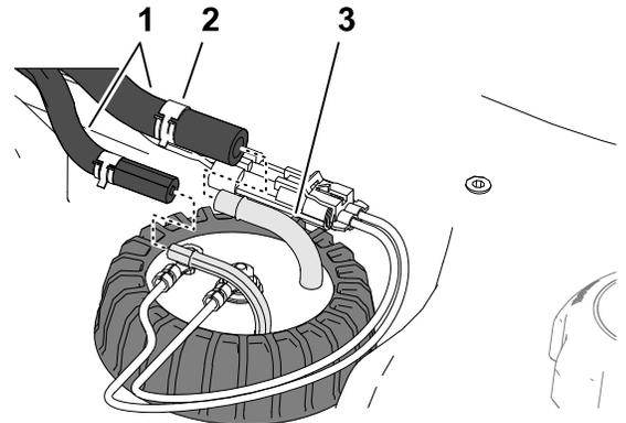
6. Enchufe el conector del arnés del sensor de combustible ② en el conector del arnés de cables de la máquina ①.
