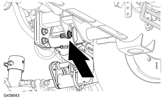
3. Afloje la contratuerca que sujeta el interruptor del brazo de elevación ① a la placa de los interruptores ②.
