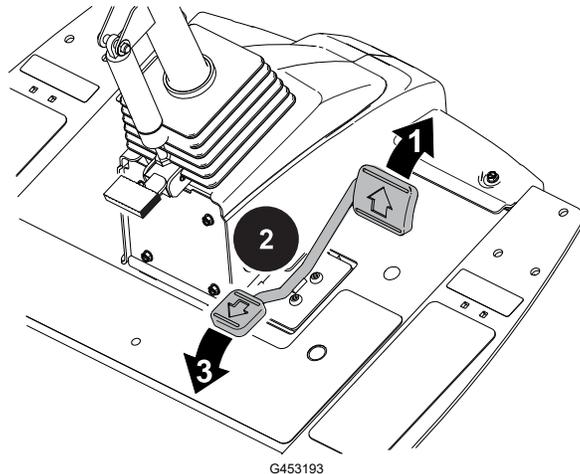
① Desplazamiento hacia delante: pise la parte superior del pedal.
