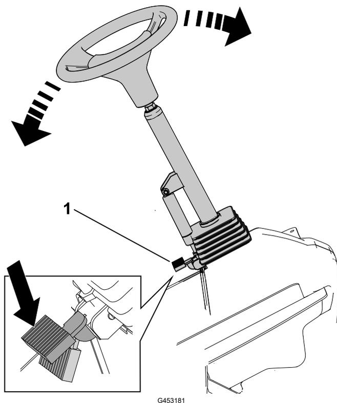
Pise el pedal de inclinación del volante ① y eleve o baje la columna de dirección a una posición cómoda.
