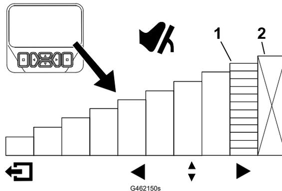
① Indica la velocidad de tracción máxima (tope del pedal)
