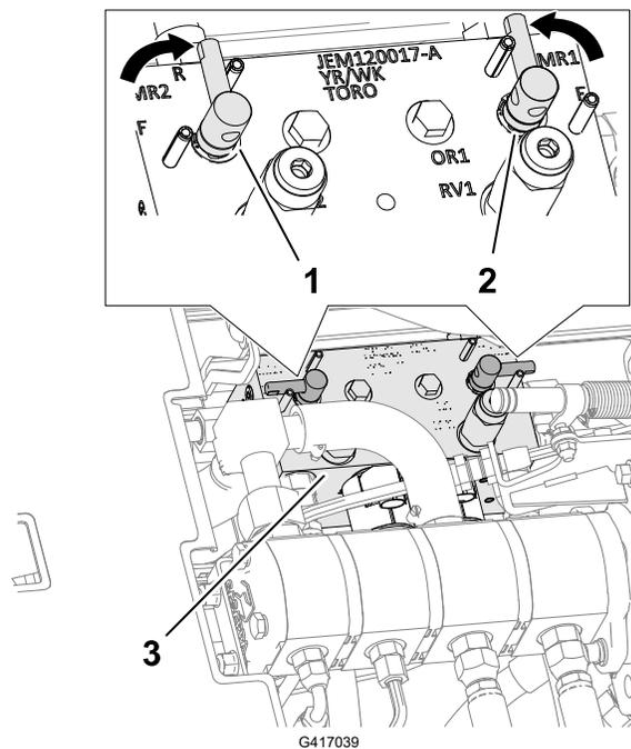
① Palanca de autoafilado (posición de autoafilado - unidades de corte delanteras)
