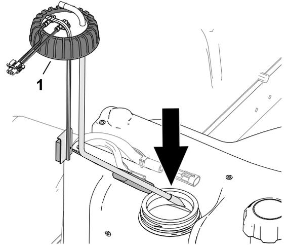
5. Conecte la manguera ① a los acoplamientos ③ del sensor de combustible, y sujete las mangueras a los acoplamientos con las abrazaderas ②.
