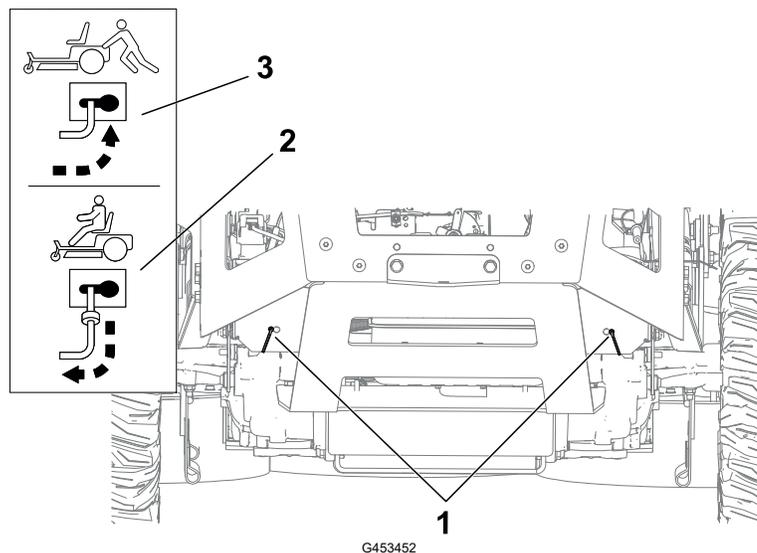
4. Poussez les deux leviers de dérivation dans la fente, puis vers le côté pour les verrouiller en position ③.
