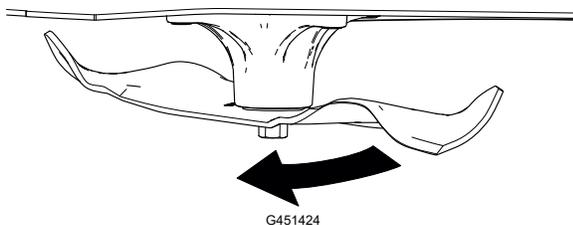
3. Mesurez la distance entre la pointe de la lame et la surface plane.
