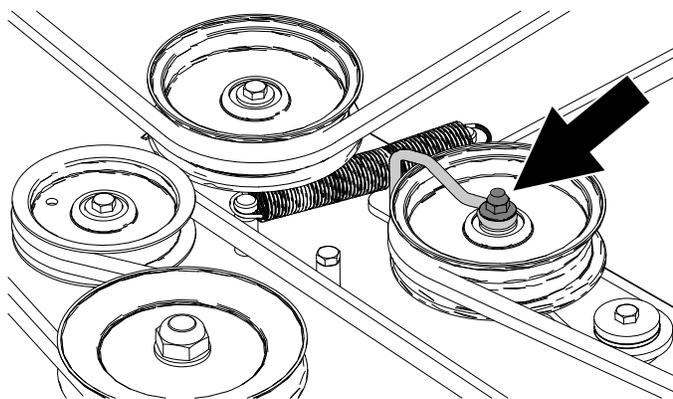
7. À l'aide d'un outil de dépose de ressort (réf. Toro 92-5771), décrochez le ressort de tension du crochet sur le plateau pour éliminer la tension sur la poulie de tension.
