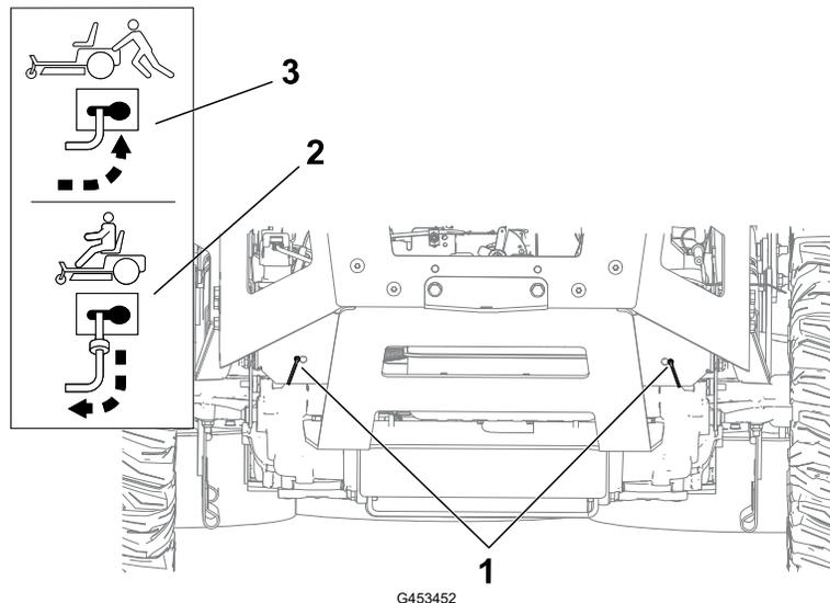
4. Schieben Sie beide Bypasshebel nach vorne durch den Schlitz und nach oben, um sie zu arretieren <sup>③</sup>.
