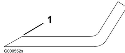
**Hinweis:** Entfernen Sie die gleiche Materialmenge von beiden Schnittkanten, sodass das Messer sein Gleichgewicht behält.
