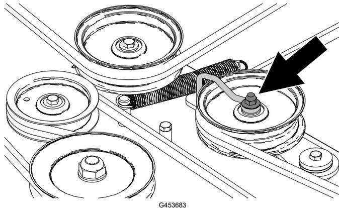
7. Entfernen Sie die Spannscheibenfeder mit einem Werkzeug zur Federentfernung (Toro- Bestellnummer 92-5771) vom Mähwerkshaken, um die Spannung von der Spannscheibe zu nehmen.
