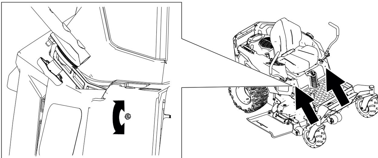
4. Ruotate il bullone per ridurre la velocità per la ruota specifica.
