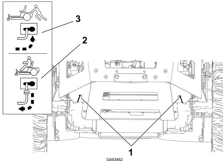
4. Spostate entrambe le leve di bypass in avanti attraverso il foro asolato e verso l'alto per bloccare in posizione <sup>③</sup>.
