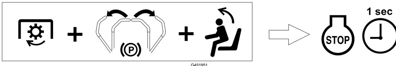
4. Sedetevi sul sedile, spostate il comando delle lame in posizione di SPEGNIMENTO e spostate le leve di controllo del movimento in posizione di PARCHEGGIO. Avviate il motore. Con il motore acceso, spostate le leve di controllo del movimento verso il centro, in posizione di sblocco, e alzatevi leggermente dal sedile: il motore dovrebbe spegnersi entro 1 secondo.
