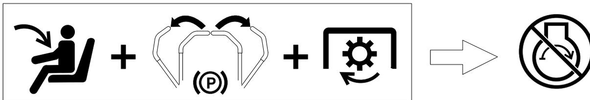
2. Sedetevi sul sedile e spostate il comando delle lame in posizione di SPEGNIMENTO. Sbloccate una qualsiasi delle leve di controllo del movimento, portandola al centro. Provate ad avviare il motore, che non deve girare. Ripetete con l'altra leva di controllo del movimento.
