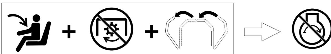
3. Sedetevi sul sedile, spostate il comando delle lame in posizione di SPEGNIMENTO e spostate le leve di controllo del movimento in posizione di PARCHEGGIO. Avviate il motore. Con il motore acceso, inserite il comando delle lame e alzatevi leggermente dal sedile: il motore dovrebbe spegnersi entro 1 secondo.
