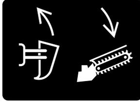
① Poussez le levier vers l'avant pour LEVER l'enfouisseuse ou ABAISSER la trancheuse/le porte-bobine hydraulique (selon l'équipement).
