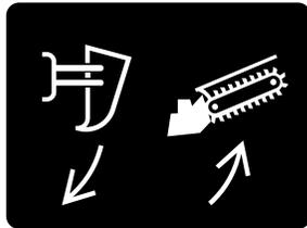
① Tirez le levier vers l'arrière pour ABAISSER l'enfouisseuse ou LEVER la trancheuse/le porte-bobine hydraulique (selon l'équipement).
