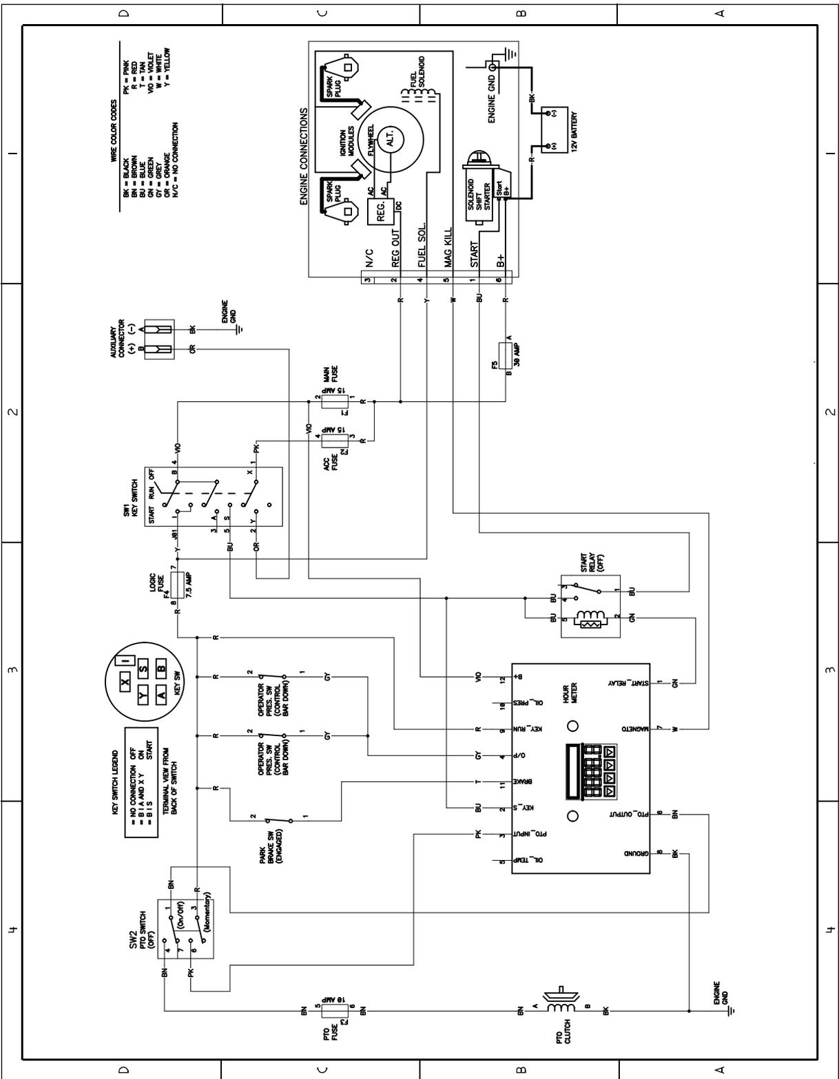
Электрическая схема DWG 131-1199 (Rev. A)
