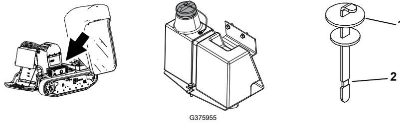
4. Retire la varilla ① del cuello de llenado y límpiela con un trapo limpio. Inserte la varilla en el cuello de llenado; luego retírela y compruebe el nivel del fluido. El nivel de fluido debe llegar a la marca de lleno ② de la varilla.
