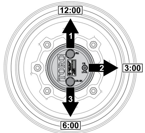
2. Retirez le bouchon de contrôle ② à la position 3 heures.
