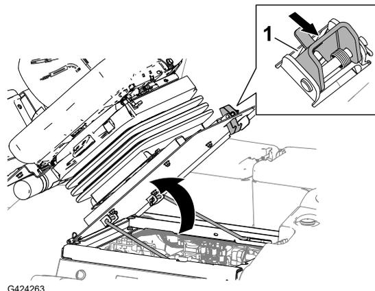
2. Engagez la béquille avant ② dans le cran de la fente de blocage sur la plaque de guidage ①.
