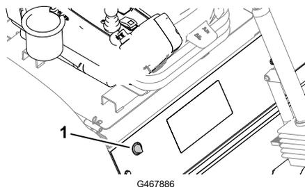
La prise d'alimentation ① fournit une tension de 12 V pour les dispositifs électroniques.
