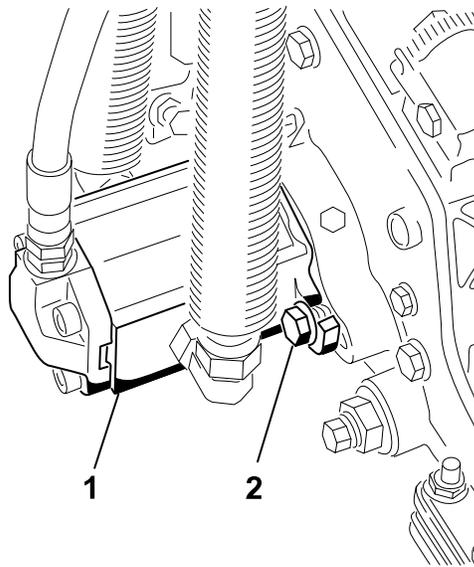
4. Tournez le moteur dans le sens antihoraire jusqu'à ce que les brides encerclent les boulons, puis serrez les boulons.
