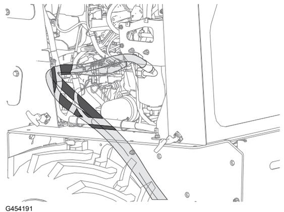
5. Conecte la manguera de 137 cm (54") al conector recto inferior de la válvula.
