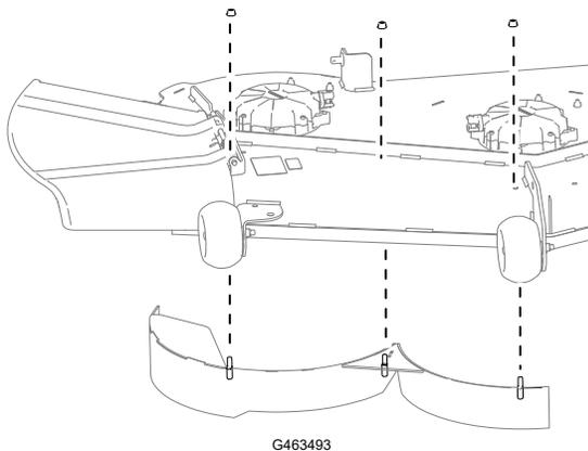
2. Sujete el tabique trasero del deflector derecho a la carcasa de corte con el perno (5/16" x 3/4") y la tuerca (5/16"), como se muestra en la figura.
