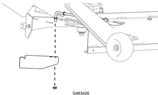
2. Vuelva a instalar la tuerca que se retiró anteriormente en la varilla de descarga.
