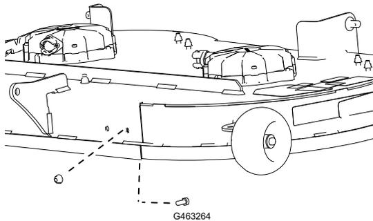
3. Fixez le côté droit du déflecteur sur le plateau à l'aide de 1 boulon de carrosserie (5/16" x 3/4") et de 1 écrou à embase (5/16"), comme montré.
