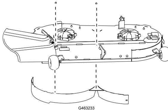
2. Fixez le côté gauche du déflecteur sur le plateau à l'aide de 1 boulon de carrosserie (5/16" x 3/4") et de 1 écrou à embase (5/16"), comme montré.
