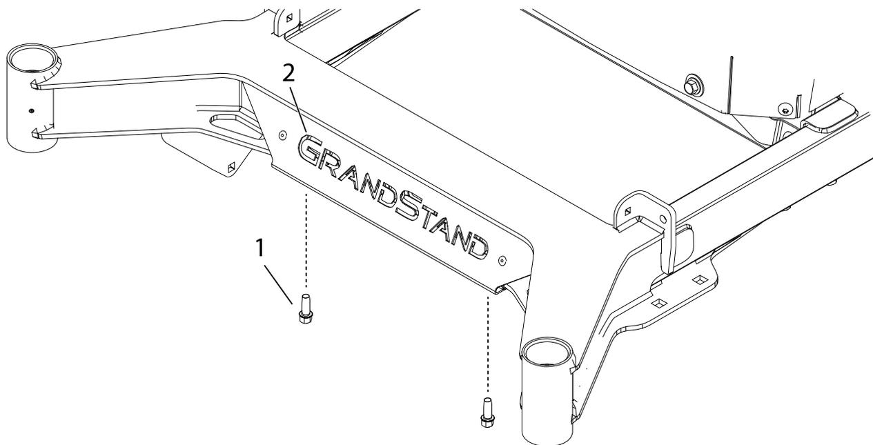
2. Comece por instalar os 2 parafusos autorroscantes ( $\frac{3}{8}$  pol.) ① usando as mãos, para evitar que estes fiquem desalinhados, a partir da parte superior da plataforma da estrutura Depois aperte com uma chave inglesa, até que fiquem bem apertados.
