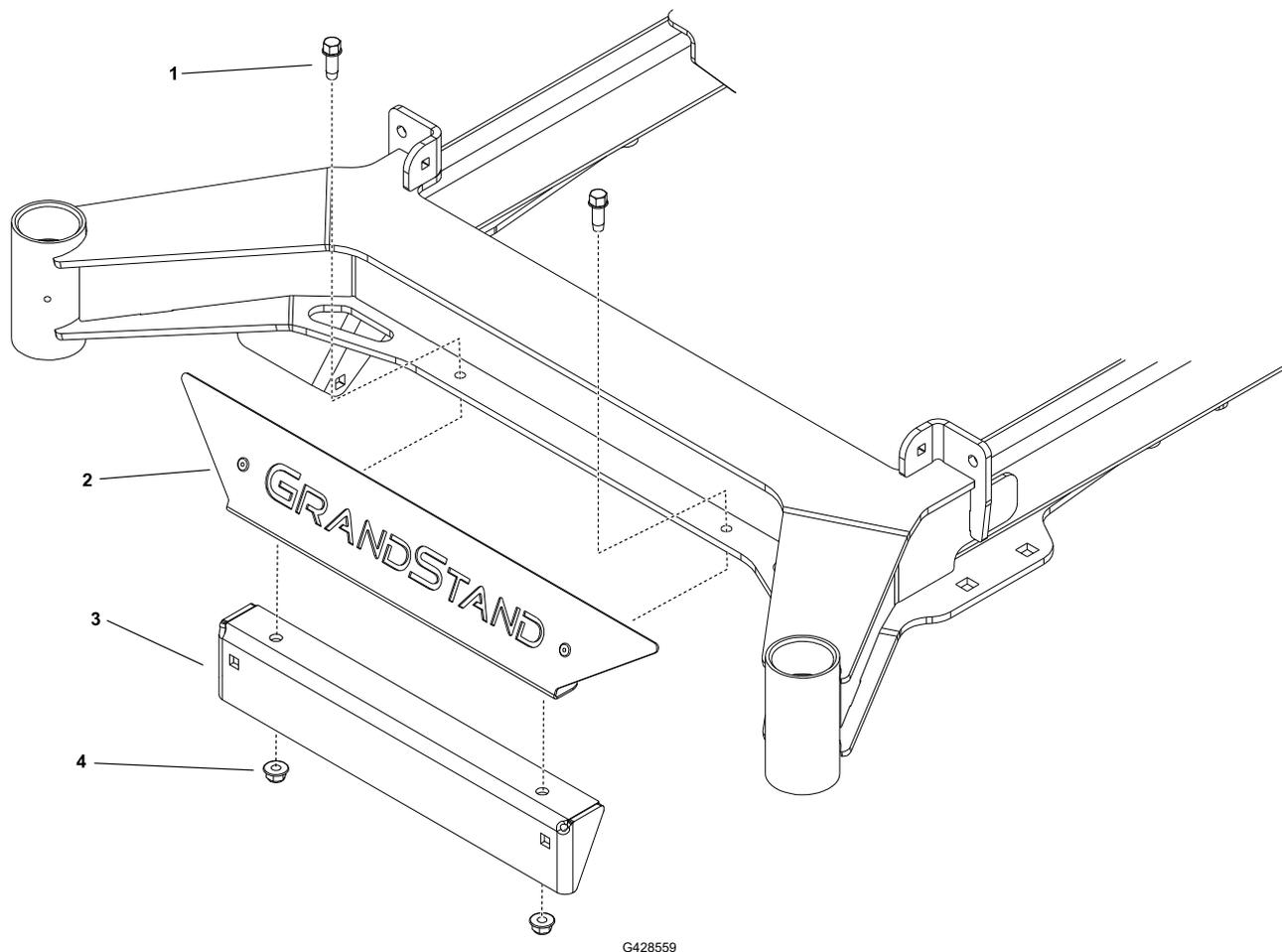
4. Instale o(s) peso(s) ③ no suporte ② utilizando 2 parafusos ① e 2 porcas de bloqueio ④.
