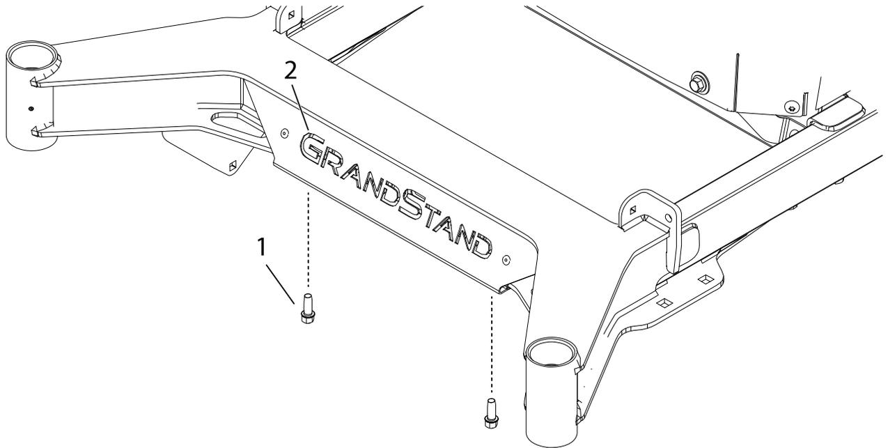
2. Installez 2 vis autotaraudeuses ( $\frac{3}{8}$  po) ① par le haut de la plaque du cadre en commençant à la main pour éviter de fausser le filetage dans le trou fileté. Serrez-la ensuite à fond avec une clé.
