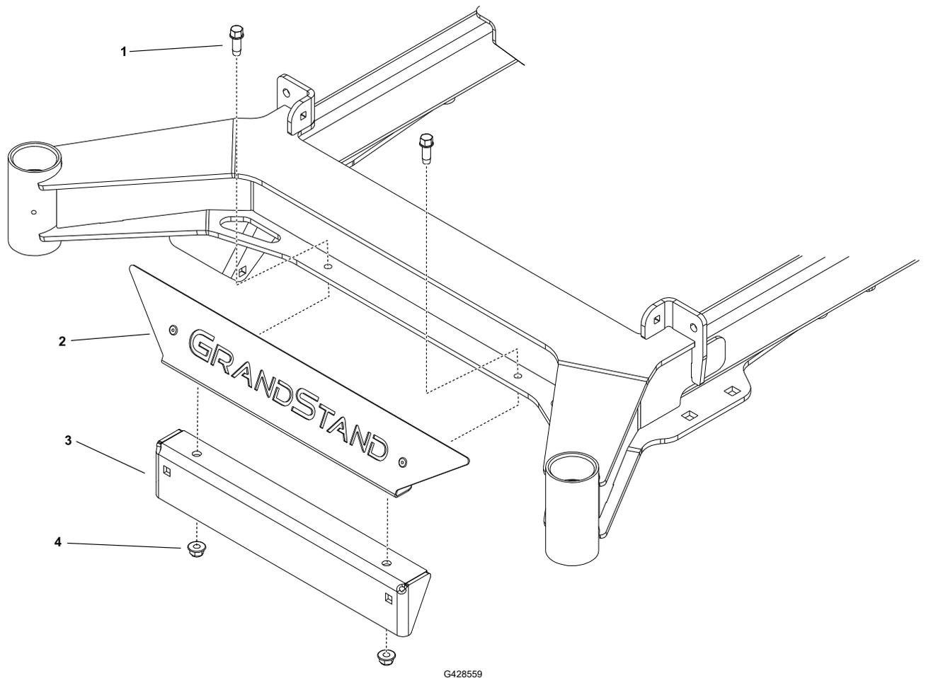
4. Fixez la ou les masses (3) sur le support (2) à l'aide de 2 boulons (1) et 2 contre-écrous (4).
