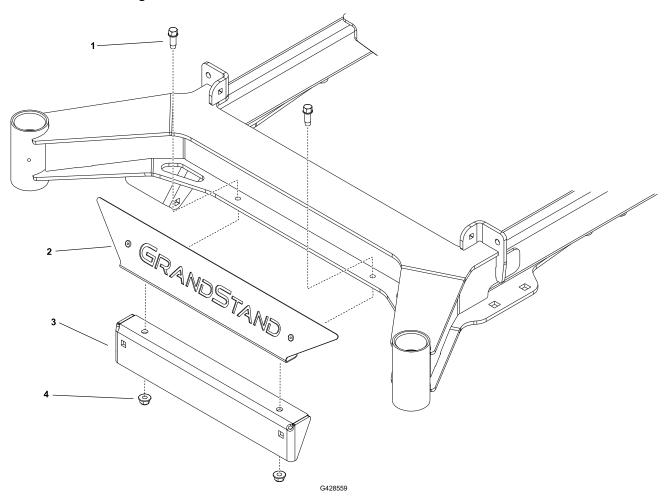
4. Befestigen Sie den Ballast ③ mit zwei Schrauben ① und zwei Sicherungsmuttern ④ an der Halterung ② .
