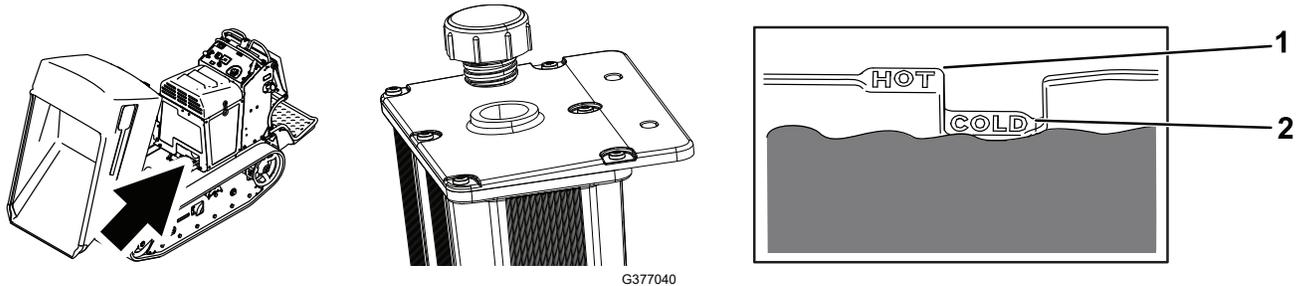
4. Mire el interior del depósito para comprobar el nivel de fluido.
