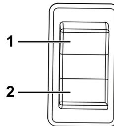
**Nota:** Si se mantiene pulsada la parte inferior del interruptor durante un segundo, la tolva baja automáticamente.
