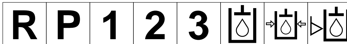
Marche arrière Parking 1ère 2ème 3ème (jusqu'au nombre maximum de rapports de marche avant) Huile hydraulique Pression d'huile hydraulique Niveau d'huile hydraulique
