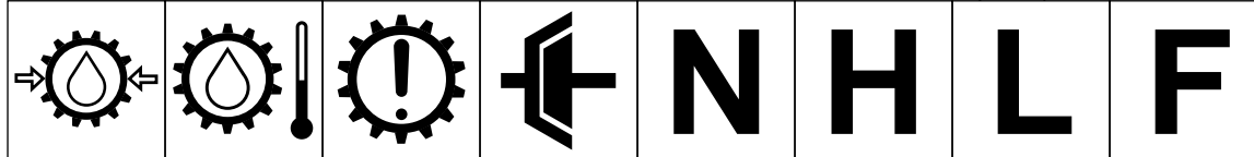
Pressione olio della trasmissione Temperatura olio della trasmissione Avaria trasmissione Frizione Folle Alto Basso Avanti
