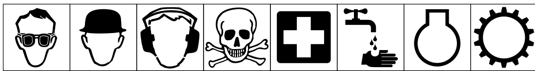
Brug øjenværn Brug hovedbeskyttelse Brug høreværn Advarsel – fare for forgiftning Førstehjælp Skyl med vand Motor Transmission
