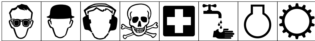
Schutzbrillenpflicht Schutzhelmpflicht Ohrenschutzpflcht Vorsicht, Giftgefahr Erste Hilfe Mit klarem Wasser auswaschen Motor Getriebe
