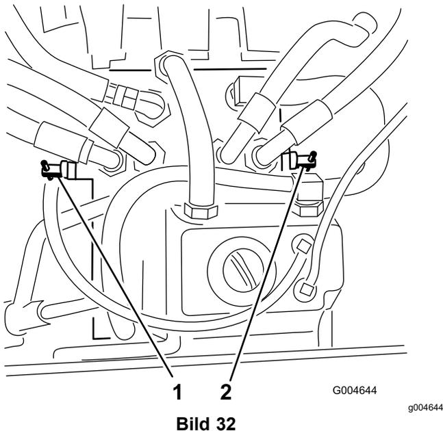
1. Rechtes Sicherheitsventil 2. Linkes Sicherheitsventil
