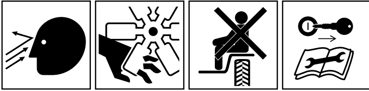
FARE FOR ANSIGTET FRA UDKASTEDE ELLER FLYVENDE GENSTANDE RISIKO FOR LEMLÆSTELSE AF FINGRENE ELLER HÆNDERNE FRA MOTORVENTILATOR PÅ MASKINER MED SIDDENDE FØRER MÅ DER KUN KØRES MED EN PASSAGER, HVIS DER ER ET PASSAGERSÆDE OG FØRERENS UDSYN IKKE ER SPÆRRET INDEN DER UDFØRES VEDLIGEHOLDELSSES- ELLER REPARATIONSARBEJDE, AFBRYD MOTOREN OG FJERN NØGLEN.
