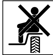
MITFÜHREN VON PASSAGIEREN AUF DIESER MASCHINE NUR AUF DEM BEFAHRERSITZ & WENN DIE SICHT DES FÄHRERS NICHT BEEINTRÄCHTIGT WIRD
