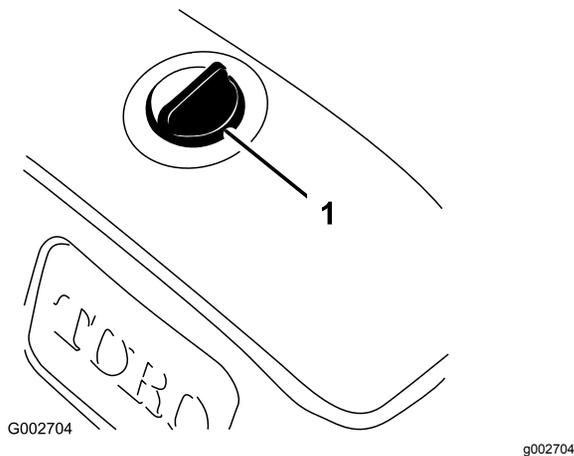
1. Bouchon du réservoir de liquide hydraulique
