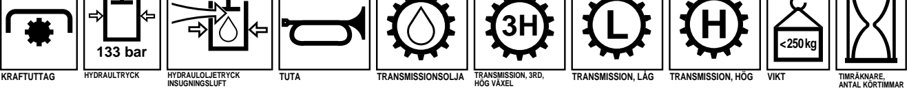
KRAFTUTTAG HYDRAULTRYCK 133 bar HYDRAULOLJETRYCK INSUGNINGSLUFT TUTA TRANSMISSIONSOLJA TRANSMISSION, 3RD, HÖG VÄXEL TRANSMISSION, LÅG TRANSMISSION, HÖG VIKT TIMRÄKNARE, ANTAL KÖRTIMMAR
