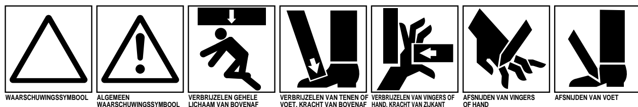
WAARSCHUWINGSSYMBOL ALGEMEEN WAARSCHUWINGSSYMBOL VERBRUIZEN GEHELE LICHAAM VAN BOVENAF VERBRUIZEN VAN TENEN OF VOET, KRACHT VAN BOVENAF VERBRUIZEN VAN VINGERS OF HAND, KRACHT VAN ZIJKANT AFSNIJDEN VAN VINGERS OF HAND AFSNIJDEN VAN VOET
