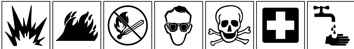
EKSPLOSJON BRANN ELLER BART LYS BRANN, BART LYS OG RØKING FORBUDT BRUK ØYEVERN SE OPP FOR GIFTFARE FØRSTEHJELP SKYLL MED VANN
