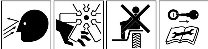
FARE FOR ANSIGTET FRA UDKASTEDE ELLER FLYVENDE GENSTANDE RISIKO FOR LEMLÆSTELSE AF FINGRENE ELLER HÆNDERNE FRA MOTORVENTILATOR PÅ MASKINER MED SIDENDE FØRER MÅ DER KUN KØRES MED EN PASSAGER, HVIS DER ER ET PASSAGERSÆDE OG FØRERENS UDSYN IKKE ER SPÆRRET INDEN DER UDFØRES VEDLIGEHOLDELSSES- ELLER REPARATIONSARBEJDE, AFBRYD MOTOREN OG FJERN NØGLEN.
